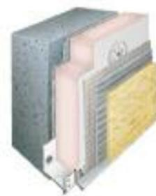
**weber.therm plus ultra** – das WDV-System mit dem Weltklasse-Dämmwert 0,022 W/mK. Kombinierbar mit einer Vielzahl unterschiedlicher Oberputze.
