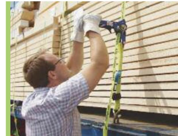
Ladungssicherung mithilfe eines Zurrratschengurtes
