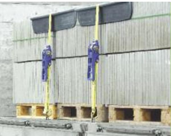
Ladungssicherung mit Zugratschengurt und Kantenschutz
