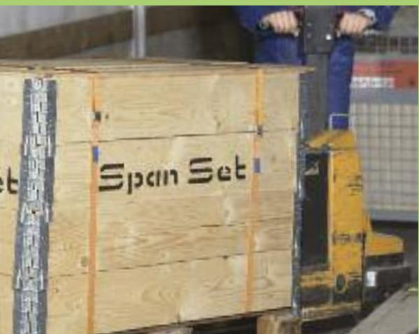
Einteilige Klemmschloss-Zurrgurte werden zur Umreifung der Ladung eingesetzt
